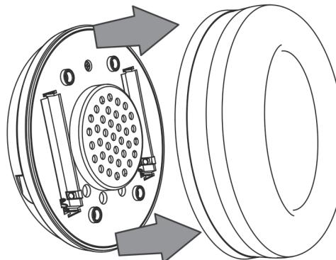
**!** Técnicamente, los cascos pueden funcionar con pilas no recargables. Se desaconseja por razones económicas y medioambientales. Observará que las baterías originales tienen su carcasa metálica visible aproximadamente 1 cm. Se trata de un dispositivo de seguridad para evitar que el casco recargue una batería convencional. Si sustituye las baterías originales por cualquier batería adquirida en el mercado, deberá cortar la parte inferior del aislamiento para garantizar el contacto de carga.
