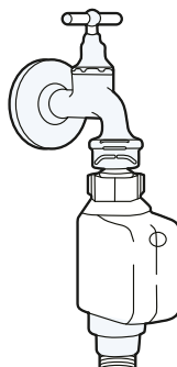
tubo de suministro de seguridad
