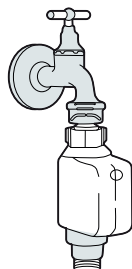
tubo de suministro de seguridad
