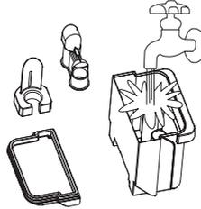
Laat alle onderdelen grondig drogen en zet ze vervolgens weer in elkaar. Monteer de vlotter en vervolgens de watertoevoerleiding. Breng het deksel opnieuw op het reservoir aan.
